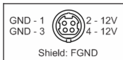
Figura 12 – Polaridade do Plug POWER DIN
